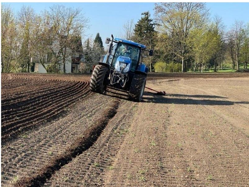
Abb. 5: Erstbewirtschaftung der Speichermulde. Um die Profilierung des Dammes zu erhalten, sind kleinere Maschinen notwendig als auf dem Rest des Schlags, © Agrargenossenschaft Radeburg eG
