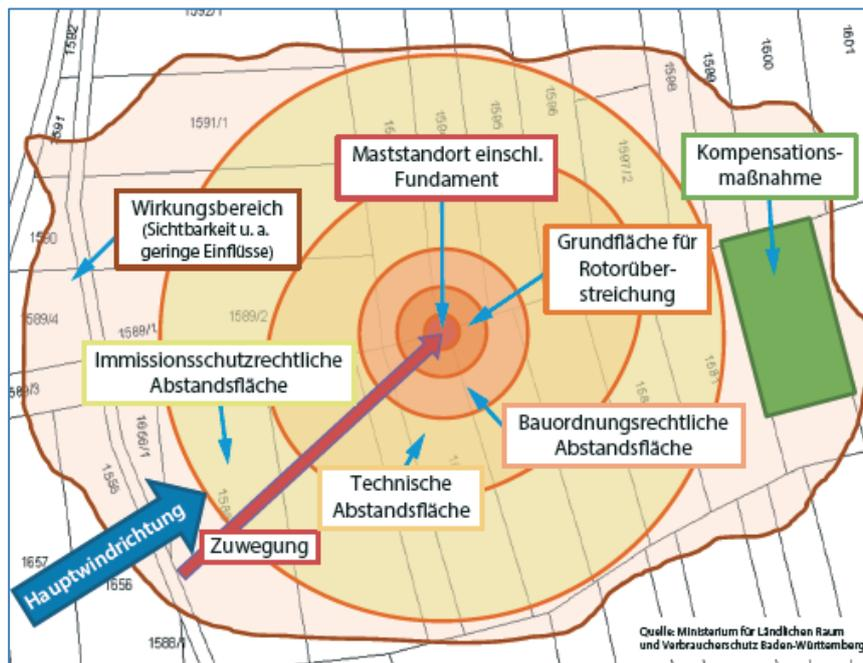
Abb. 1: Schematische Darstellung einer WEA (Quelle: MLR Baden-Württemberg)
