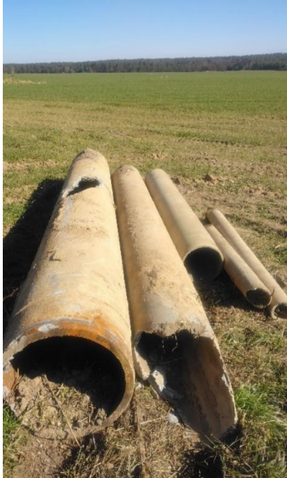
Abb. 1 – Teilstücke der alten Brauchwasserleitung aus Asbestzement
