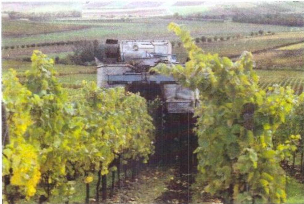
Bild 1: Selbstfahrender Traubenvollernter
