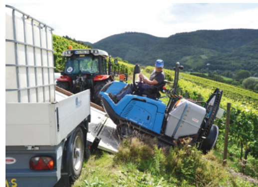
Raupenmechanisierungssystem beim Einsatz im Pflanzenschutz in einer Steillagen-Falllinienbewirtschaftung (Quelle: Huber)
