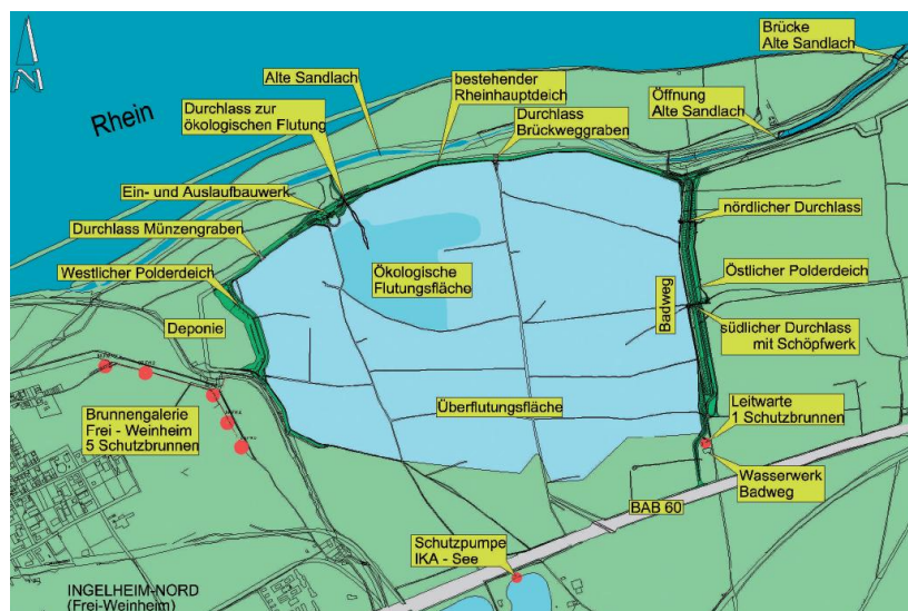
Abbildung 51: Übersicht Baumaßnahmen Polder Ingelheim 54
