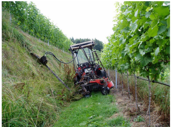
Abb. 22: Schräg stehender Schlepper auf Grund zu großer Innenneigung der Plattform
