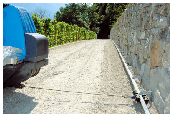
Abb. 8: Schiene mit Laufkatze zur Arbeit mit dem RMS ohne Schlepper und Anhänger
