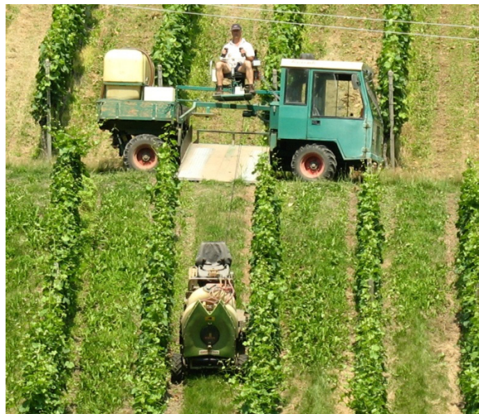
Abb. 5: Der RETRAK beim Einsatz im Pflanzenschutz mit ferngesteuertem Geräteträger
