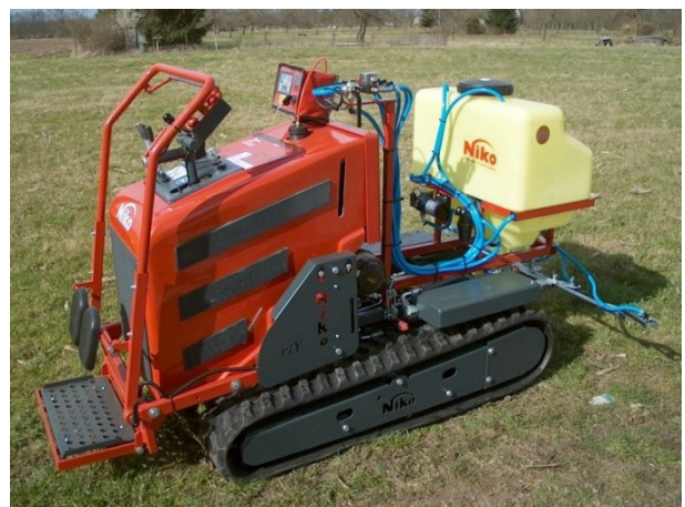
Abb. 25: Typische Raupe mit Trittbrett der Fa. Niko, ausgestattet mit Herbizidspritzgerät, zusätzlich kombinierbar mit Mulchgerät
