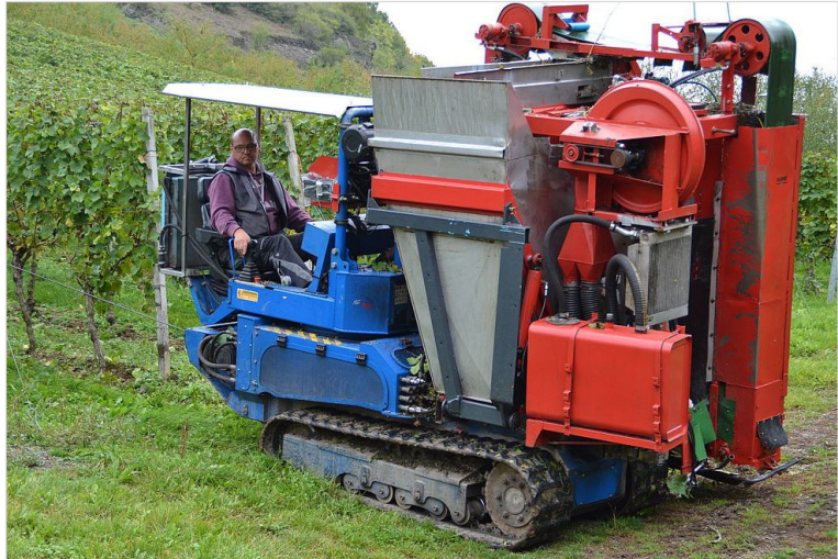
Abb. 10: Steillagenvollernter des Lohnunternehmens Müller
