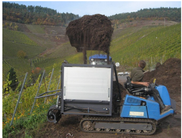
Abb. 27: Kompoststreuer auf einem RMS der Fa. Geier
