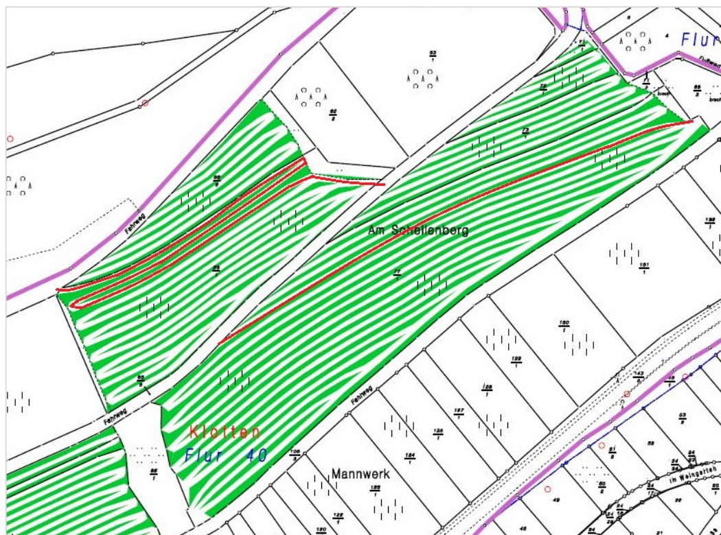
Abb. 55: Schräg verlaufende Terrassen im östlichen Teil, zur besseren Erschließung
