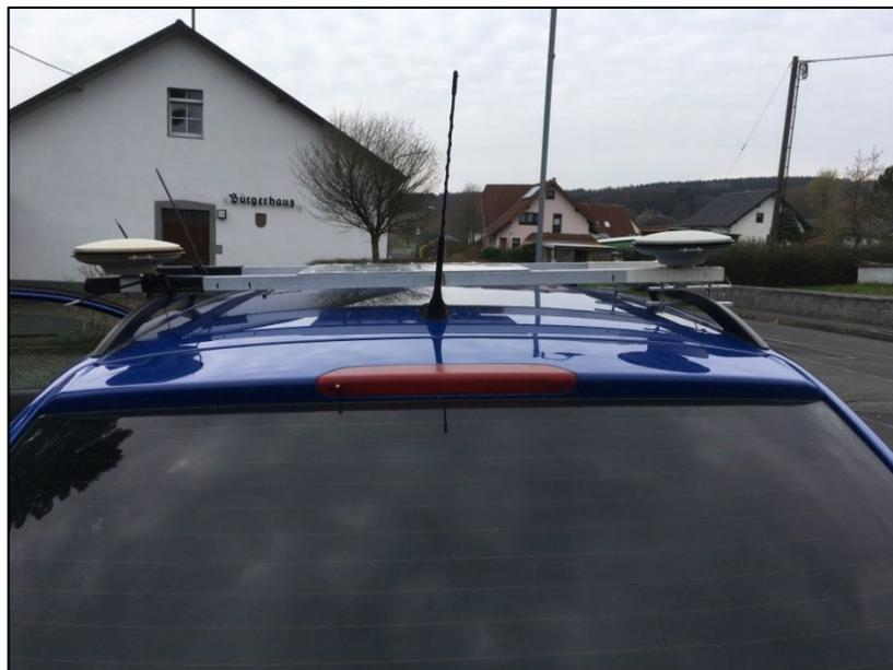
Abbildung 4-8 Antennen mit Dachträger auf einem Auto
