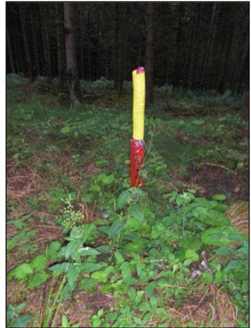
Abbildung 3-7 zusätzliche Kennzeichnung einer Eigentumsgrenze mit Plastikrohr und eigener Nummerierung des Flurstücks durch den Waldeigentümer im Waldflurbereinungsverfahren Lissingen (Quelle: [Hinz (2012e)])
