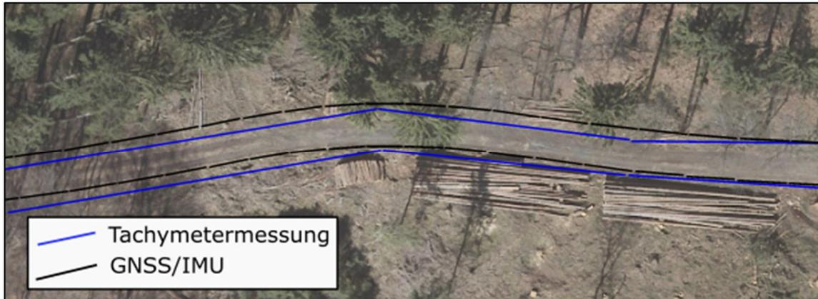
Abbildung 5-18 Gegenüberstellung Tachymetermessung zu GNSS/IMU
