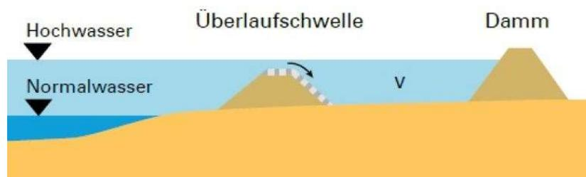
Abb. 9: Prinzip eines ungesteuerten Rückhalts (Polder) mit Überlaufschwelle (Quelle: BUND 2009, S.2)
