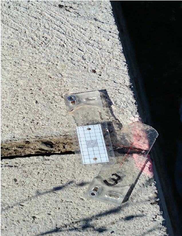
Abbildung 21: Rissmonitor an Kontrollpunkt
