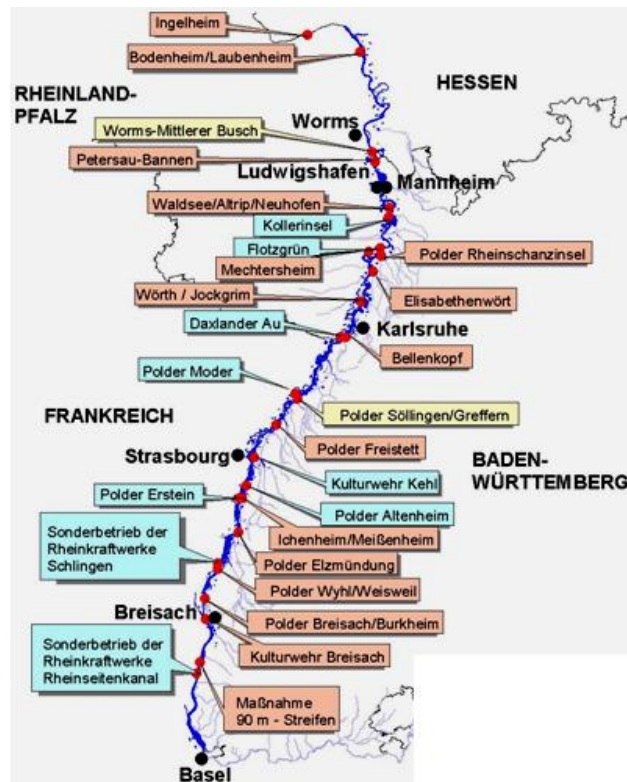
Abbildung 10: Übersicht der Hochwasserrückhaltmaßnahmen am Oberrhein 12
