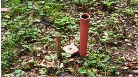
**Abb. 3-32:** Vermarkung einer abgehenden Eigentumsgrenze durch Grenzstein daneben Kennzeichnung der Flurstücksnummer auf Holzpflock zur Besitz-einweisung sowie zusätzliche Kennzeichnung durch den Waldeigentümer mit langem Eisenrohr im Waldflurbereinigungs-verfahren Hinterhausen-Büdesheim (Hinz 2010)
