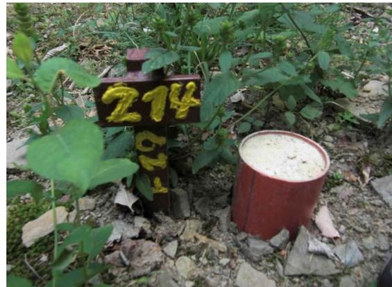
**Abb. 3-35:** Zusätzliche Kennzeichnung einer Eigentumsgrenze mit Plastikrohr und eigener Nummerierung des Flurstücks durch den Waldeigentümer im Waldflurbereinigungs-verfahren Lissingen (Hinz 2010)
