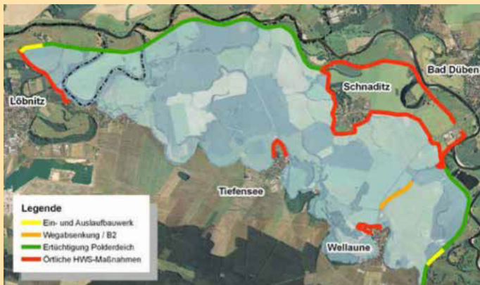
Abb.3: Übersichtsplan Polder Löbnitz mit den geplanten Maßnahmen
