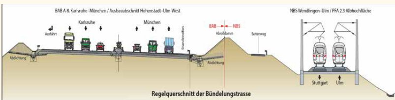
Abb. 1: Regelquerschnitt A8/ICE Trasse. Breite zwischen 90 und 130 m
