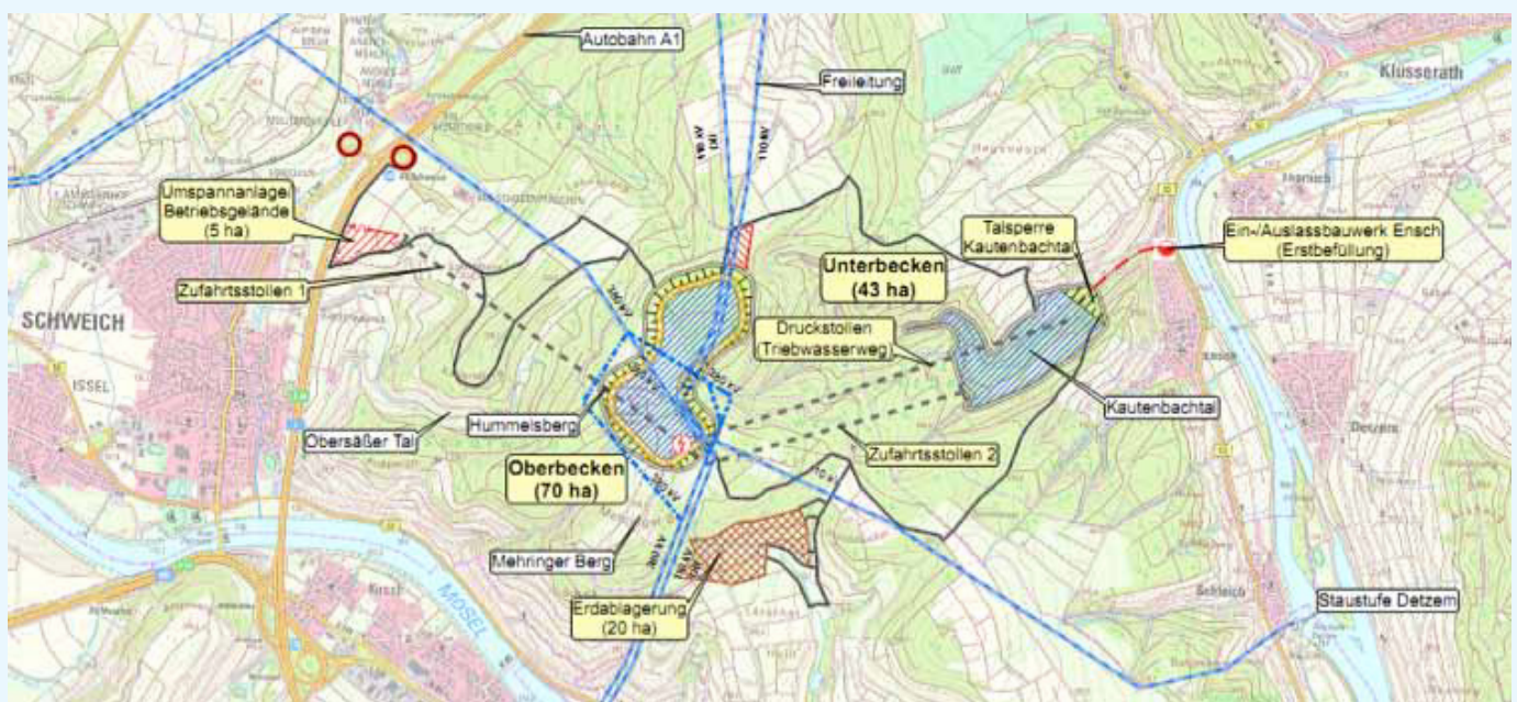
Abb. 24: Geplante Lage des Pumpspeicherwerks Rio – Quelle: Raumordnungsverfahren
