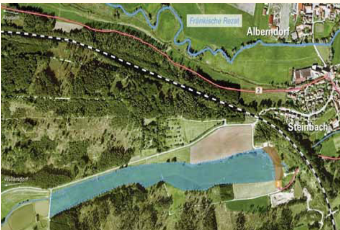
Abb. 3: Ein 100 Meter langer und bis zu 5 Meter hoher Damm schließt das schmale, langgezogene Silberbachtal ab.
