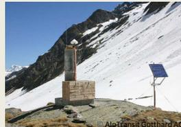
GPS-Permanentstation zur Überwachung von Geländedeformationen über dem Tunnel
