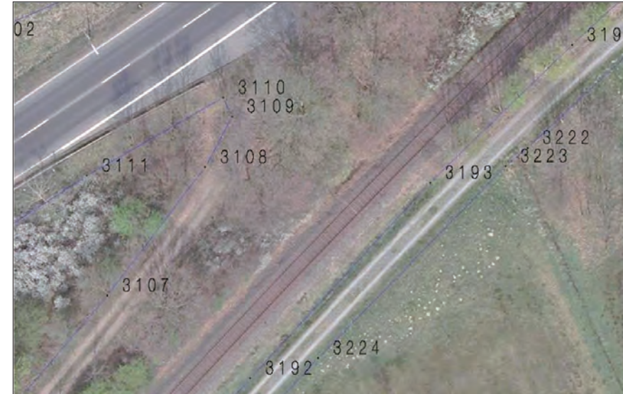
Abbildung 8: Punktfestlegung im Stereomodell (Quelle: DLR RhPf)
