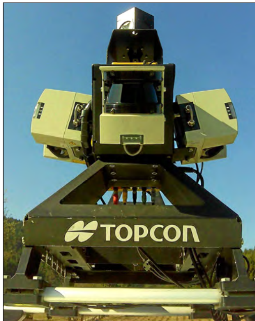
Abbildung 5: Eagle-Eye-Technologie mit kinematischer Vermessungsmethode unter Verwendung hybrider Multi-Sensor-Erfassungssysteme (Quelle: TOPOCON)
