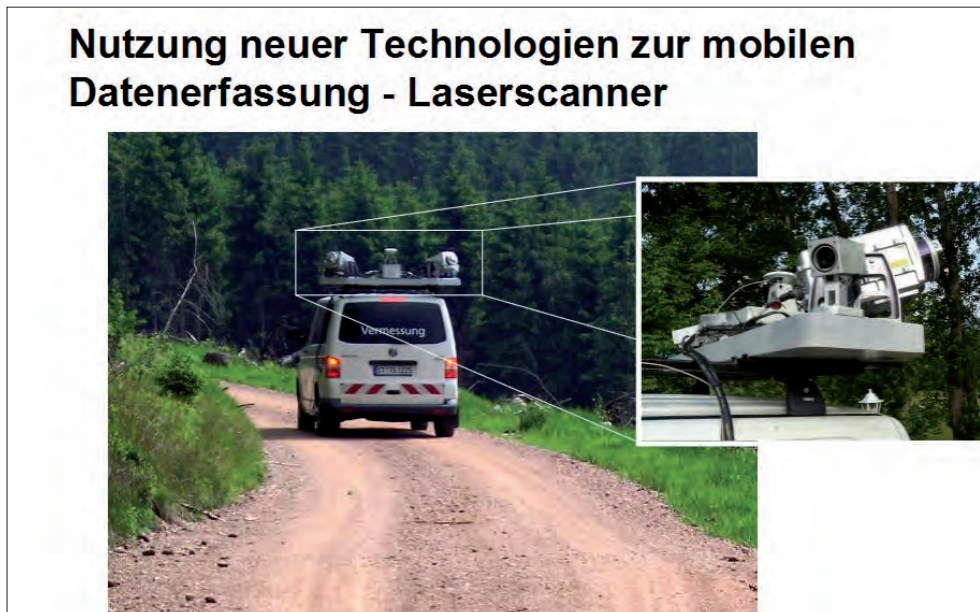
Abbildung 6: Technische Ausstattung zur mobilen Erfassung von Geodaten mittels Laserscanner (Quelle: U.Heitze)
