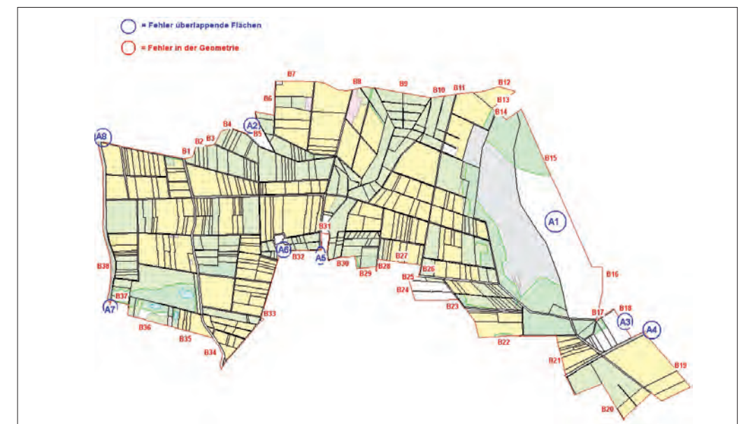
Bild 3: In der FG24.2 wird die Verfahrensgrenze abgeglichen. Die Analyse zeigt Abweichungen zwischen den aktuellen Geobasisdaten der ALKIS-Datenhaltungskomponente und den Daten der Flurbereinigung in Form von die Verfahrensgrenze überlappenden Flächen und Geometrieabweichungen.
