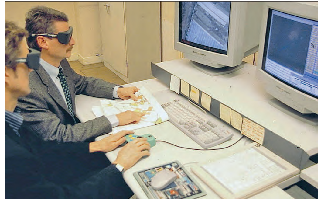
Abbildung 7: Der digitale Stereoplotter Zeiss PHODIS ST 30 ist vielseitig einsetzbar. (Quelle: Fehres)
