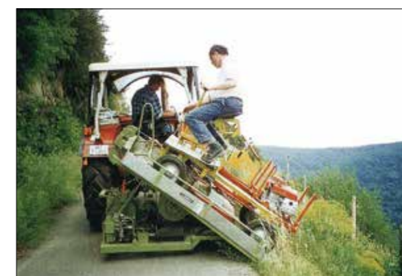
Abb. 1: Geräteträger mit Mulchgerät beim Umsetzen auf der Auffahrpritsche
