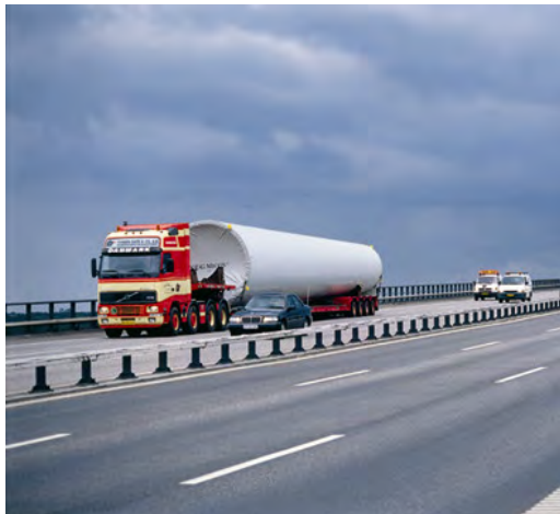
Abbildung 2.1-6: LKW für Turmtransport [Internet: Bundesverband WindEnergie, Stand: 08.02.2009]
