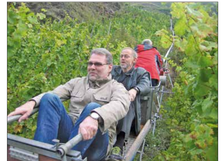
Abb. 3: Die Monorackbahn als Transportmittel (Quelle: Stefan Taxis)
