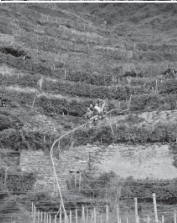
Erschliessung extrem steiler Hanglagen durch Monorack-Einschienezahnradbahnen
