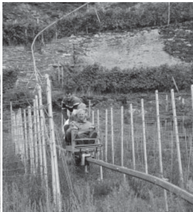
Erschliessung extrem steiler Hanglagen durch Monorack-Einschienezahnradbahnen
