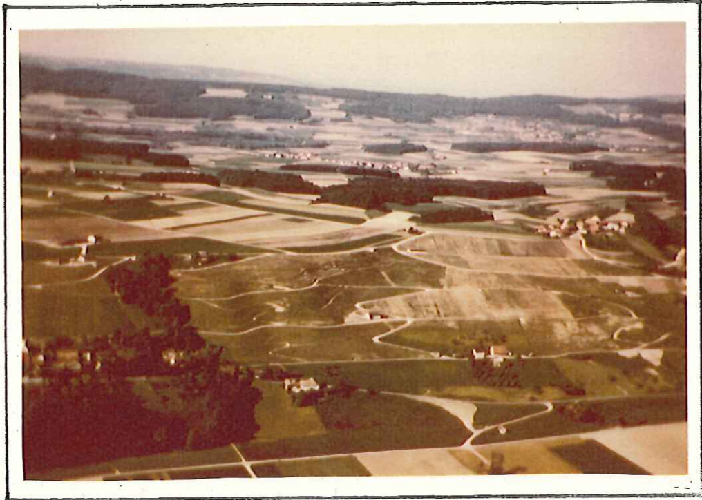
Abb. 25: Terrassierung des Rebberges Üsslingen (Frontaufnahme). Der steilere, links im Bild gelegene Teil des Hanges wurde terrassiert. In diesem Hang ist das Wegenetz viel zu dicht, die horizontalen Wege sind tlw. überflüssig.
