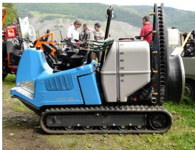
Abbildung 20: hydrostatische Raupe, Steigfähigkeit ~60%
