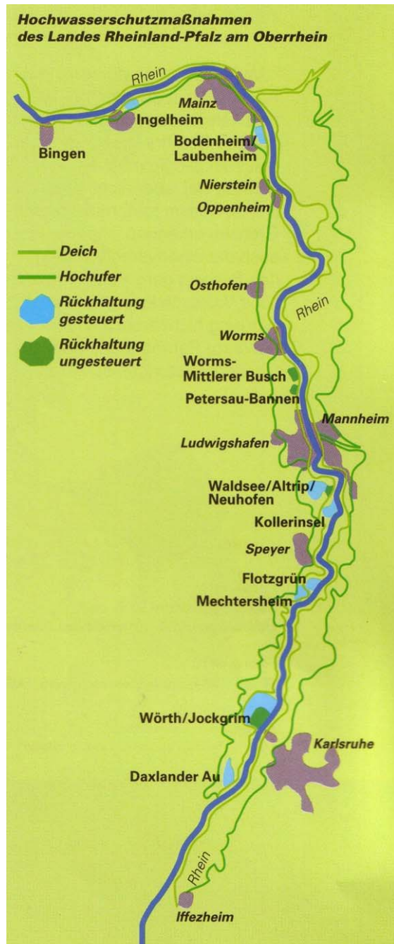
Abbildung 4.7: Übersicht der geplanten Rückhaltungen am Oberrhein
