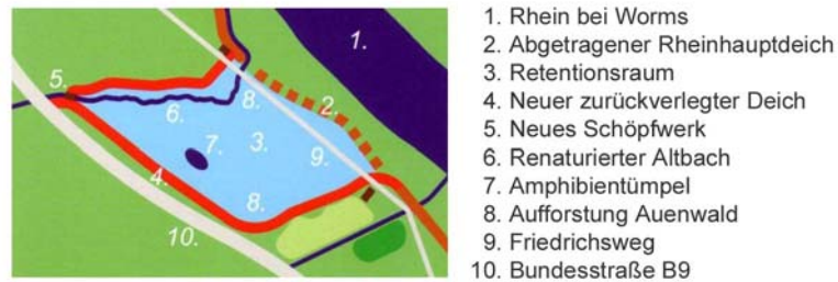
Abbildung 6.53: Schema der Deichrückverlegung Worms „Bürgerweide“
