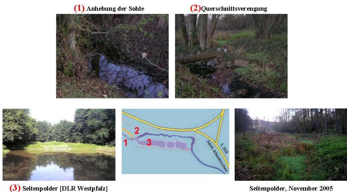
Abbildung 5-24: Maßnahmen im Bereich des Polderbauwerkes
