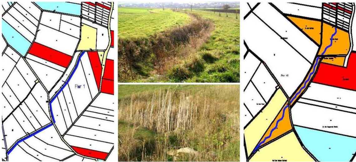
Abbildung 5-33: Gewässerverlauf vor (links) und nach (rechts) der Renaturierungsmaßnahme Mitte: offener, naturnaher Graben und Sickermulde, November 2005
