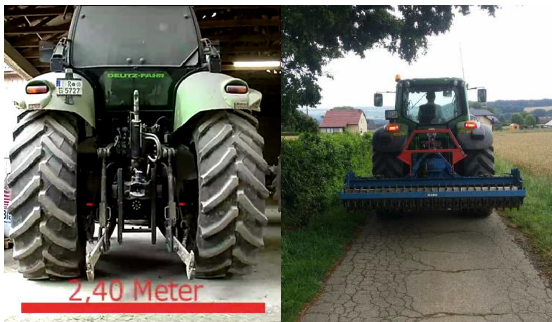
Abbildung 4 und 4.1: Die Breite eines heutzutage üblichen Traktors beträgt ca. 2,4m und die daraus entstehenden Schäden eines viel zu schmalen Wirtschaftswegs (Quelle 4: M. Feuerer, 4.1: DLR Eifel)
