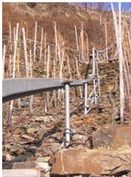
Abbildung 1: Verlauf eines Schienenstranges mit vertikaler und horizontaler Biegung
