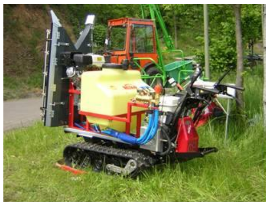
Abbildung 4: handgeführte Raupe mit Sprühvorrichtung
