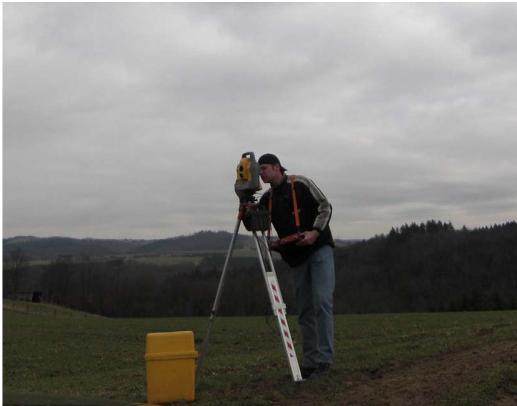
Abbildung 15: Aufmessung vor Ort mit Tachymeter und Feldrechner
