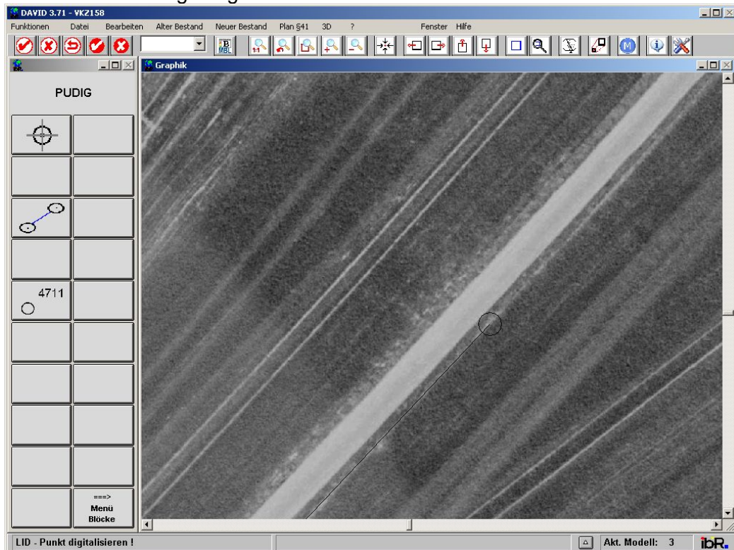
Abbildung 4: Digitalisieren in GRIBS (erfassen einer Wegeseite)
