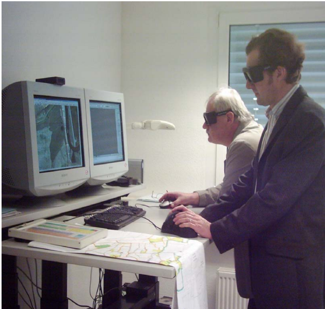
Abbildung 10: Digitaler Stereoplottter DAT/EM Summit Evolution samt AutoCAD
