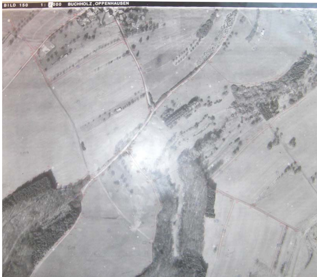
Abbildung 2: Analoges Orthophoto Maßstab 1:1000 mit einbelichteten Passpunkten
