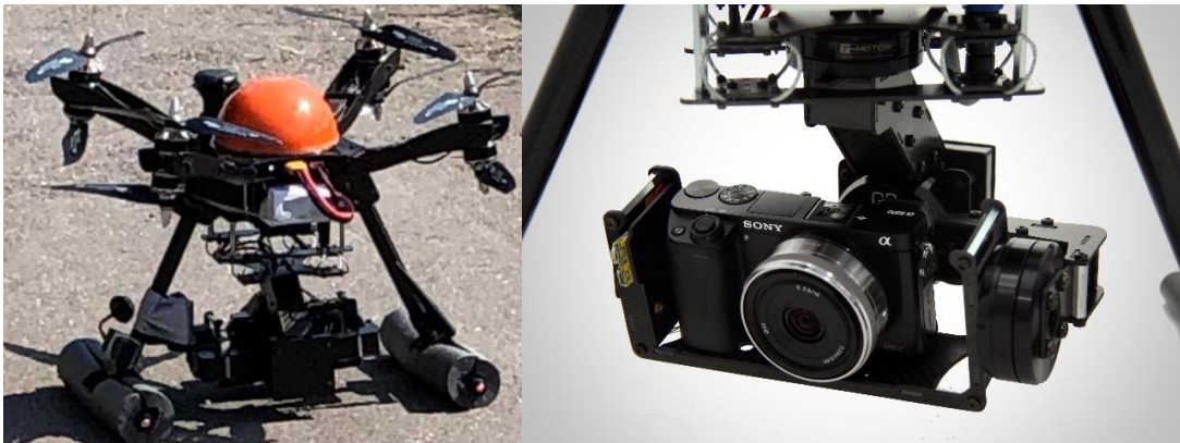
Abbildung 27: Drohne RKM 8X und Gimbal (ArduPilot, 2019)
