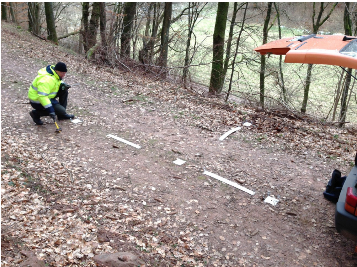
Abb. 3-12: Signale und Aufnahmepunkte mit temporären Sicherungspunkten (Baadte, 2014)
